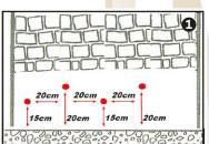
Percez les trous jusqu'à 75% de l'épaisseur du mur. Les murs ayant une largeur supérieure à 55 cm devront être percés des deux côtés.
